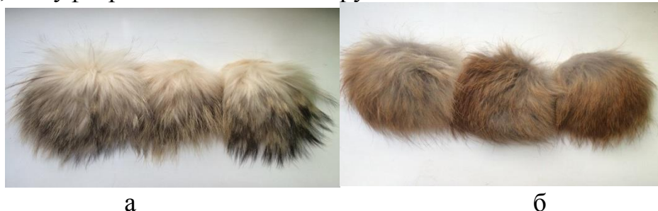
Рисунок 3 – Образцы меха после проверки на устойчивость к сваливанию: а – енотовидной собаки; б – лисицы огневки
