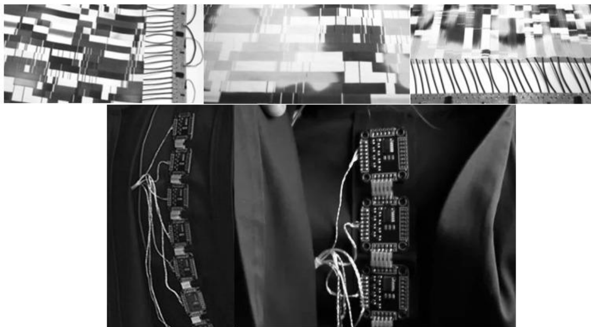
Рисунок 1 - Схема вплетения в ткань нихромовых проводов
