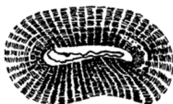
Рисунок 1 – Поперечный разрез хлопкового волокна
